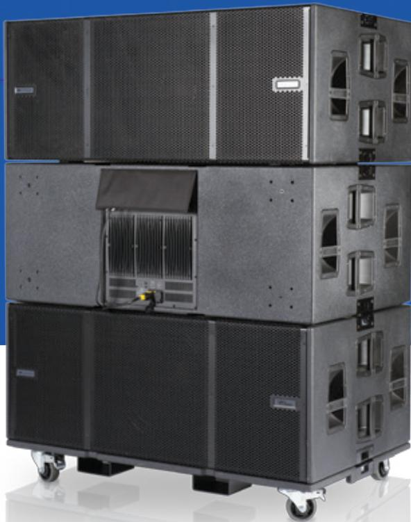
在使用3只超低音箱的心型配置里，“cardioid”（心型）按键可以自动处理将超低音面向背面，以达到到最大抵消。超低音顶部的凹槽方便线缆在扬声器之间穿越。
